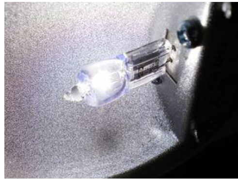
شكل (2.19): مصباح هالوجين دون الزجاج المحمي المصدر: (ويكيبيديا، 2010م)
