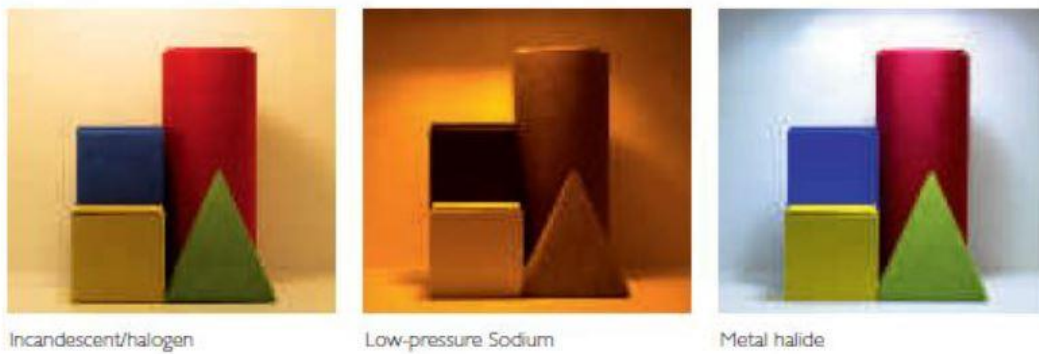
شكل (4.41) الأداء اللوني لبعض مصادر الإضاءة الصناعية
