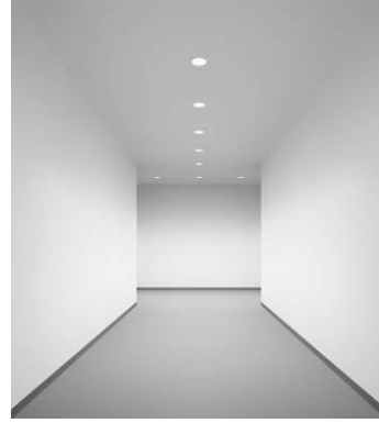
شكل (3.50): الانارة الناتجة عن جهاز منير الجدارين ينير الجدارين ويحد الوهج باتجاه
