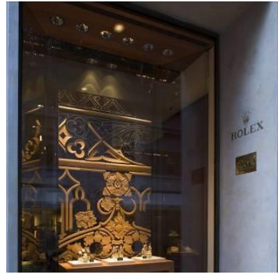
شكل (3.63): استخدام اجهزة سبوت لايت غاطسة في السقف لتحقيق انارة مركزة على الاشياء المهمة التي يريد المصمم ابرازها.
