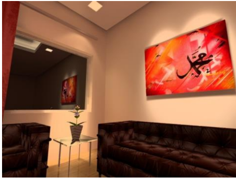
شكل (3.68): الصورة والمزهريّة عليها نفس كمية شكل (3.69): الصورة والمزهريّة عليها مستوى انارة اكثر بخمس اضعاف من الانارة العامة الموزعة بالغرفة مما يجعلها جذابة وافضل
