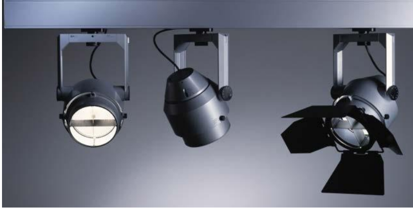
شكل (3.67): أجهزة مع ملحقات حجب الوهج لزيادة الراحة البصرية عند إمالة الأجهزة أكثر من الزاوية 30^\circ مع الخط العمودي.
