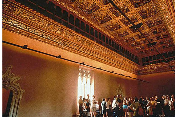
شكل (3.18): الشكل المعماري لسقف يتطلب وجود انارة غير مباشرة شكل (3.19): أجهزة إنارة غاطسة في الجدار لإضاءة السقف
