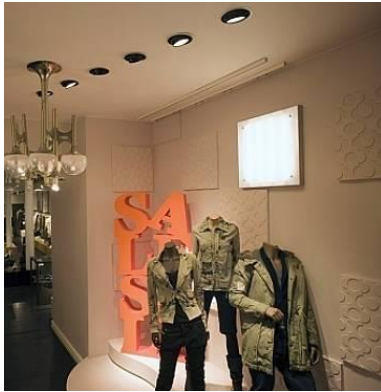
شكل (3.63): استخدام اجهزة سبوت لايت غاطسة في السقف لتحقيق انارة مركزة على الاشياء المهمة التي يريد المصمم ابرازها.
