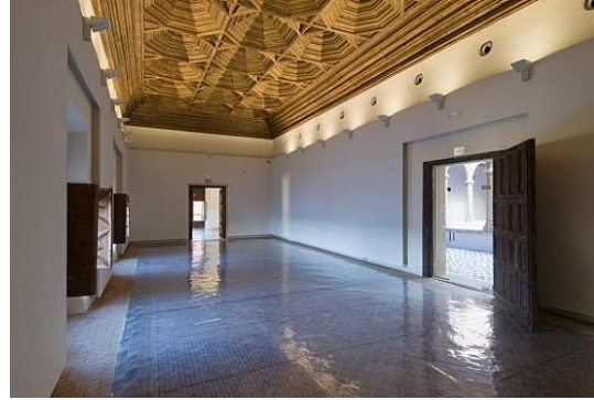
شكل (4.31): إنارة غير مباشرة من السقف مع وجود أرضية لامعة
